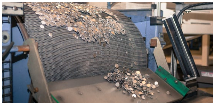
Flans fabriqués grâce à la technologie de placage multicouche sur acier de la Monnaie, qui réduit grandement la dépendance aux dispendieux métaux communs.
